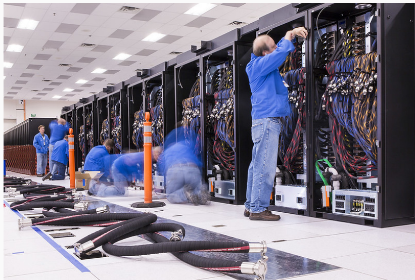
Câblage du super-calculateur Trinity
